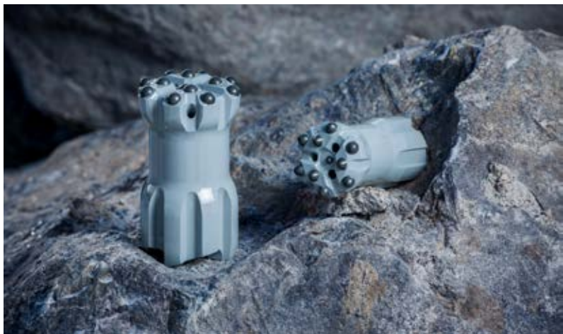
Olika användningsområden och markförhållanden kan göra det svårt att få ut mesta möjliga ur borrarstämlet. Med borkronor, kopplingar och stänger i Epiroc Grey line-serien med högkvalitativt stål optimeras bergbörning i mindre krävande bergförhållanden.
