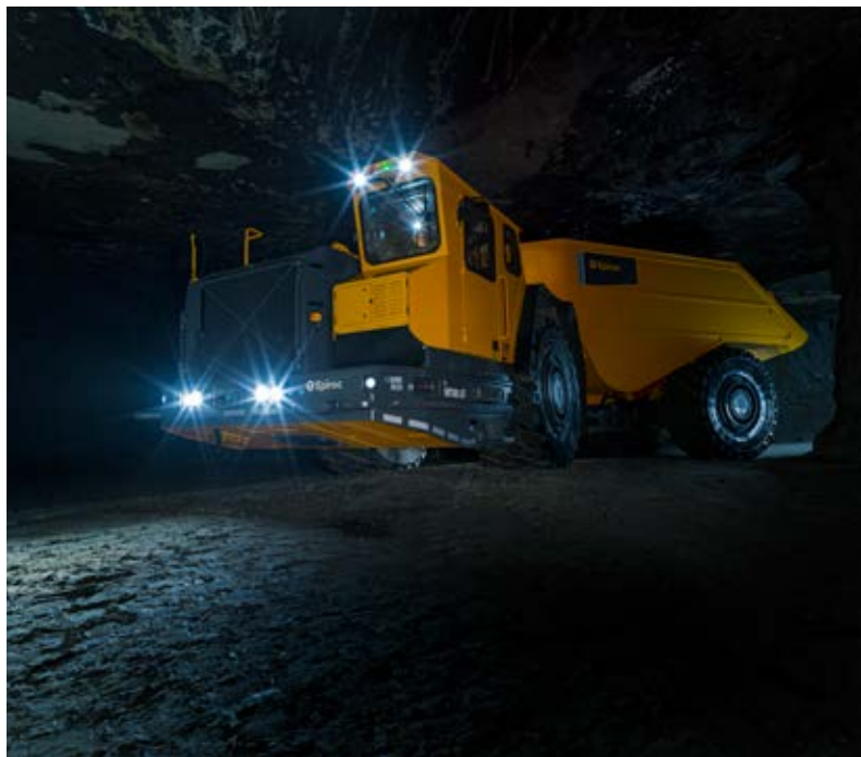
En av våra mest populära maskiner under jord är gruvtrucken Minetruck MT42. Den är en snabb 42 tons truck, med toppmoderna säkerhetssystem och den körs bekvämt vilket resulterar i oslagbar prestation i verksamhet under jord. Självklart erbjuder Epiroc också en batterielektrisk version.
